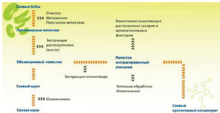
Рис.1. Общая схема спиртовой экстракции соепродуктов с получением соевого концентрата
